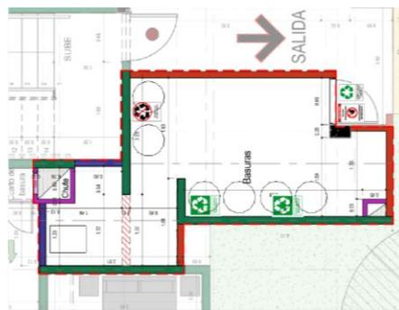
Planta típica – Chute y cuarto de basuras, torre típica.
